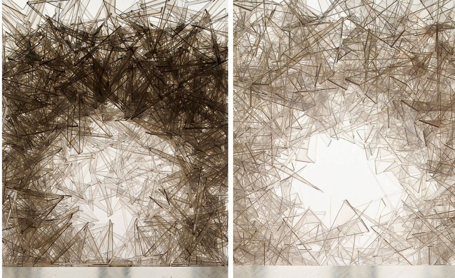
Figur 04: Vergleichende Rücklichtphotographie von Granulaten aus vornehmlich konvexen (rechts) und konkaven (links) Partikeln, Autoren: Guobin Shen, Sabrina Heldele, Tutoren: Karola Dierichs, Achim Menges.
